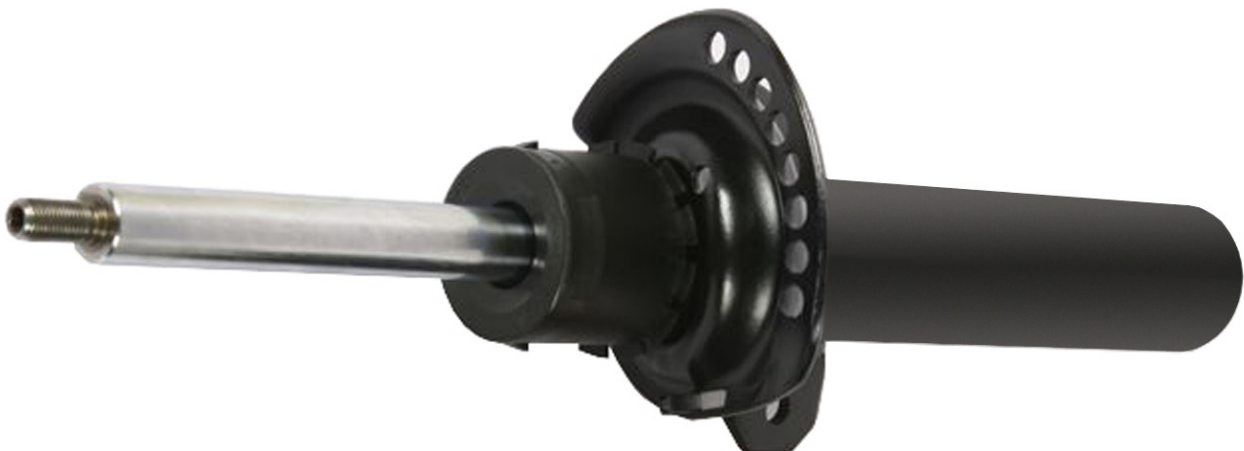
Fig. 2: Grooveless piston rod
