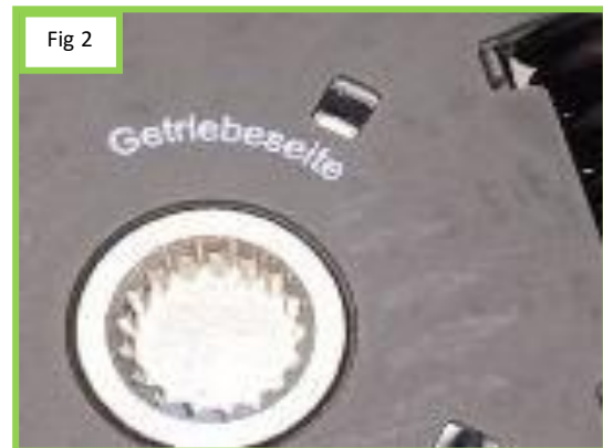
Getriebeseite (gearbox side) on the friction plate
