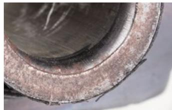
**DE** Durch eine mechanische Behandlung der Lagerflächen wird der Korrosionsschutz entfernt. Diese Behandlung wird durchgeführt um die Anlagefläche der Schraube zu vergrößern. Das Vorhandensein von Rost ist abhängig von der Lagerzeit / Luftfeuchtigkeit und beeinträchtigt nicht die Funktion der Produkte. Ein nachträglicher Schutz der Oberflächen kann zu einer Funktionsbeeinträchtigung führen.
