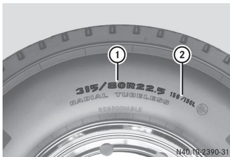
Tamaño del neumático e índice de capacidad de carga (ejemplo)
