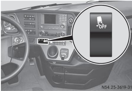
Al poner en marcha el motor, el asistente de regulación de la estabilidad se conecta de forma automática.
