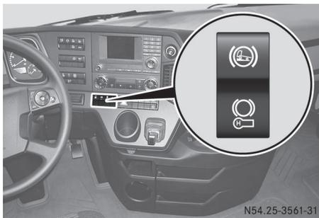
El freno de paradas consume menos aire comprimido que el freno de estacionamiento. Si inicia la marcha con frecuencia y se detiene brevemente, utilice el freno de paradas, por ejemplo, en el servicio de recogida de basuras. El freno de paradas no sustituye ni al freno de servicio ni al freno de estacionamiento. Encontrará más información sobre el estacionamiento del vehículo en el apartado "Parada y estacionamiento" (▷ página 262).
