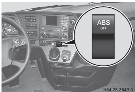
El sistema ABS se conecta automáticamente cuando pone el motor en marcha. Si desconecta el ABS, puede acortarse el recorrido de frenado al circular por terrenos no asentados (por ejemplo, con un firme blando). Solo puede desconectar el ABS del vehículo tractor.
