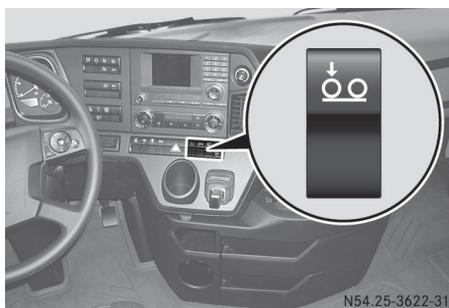
Utilice la ayuda para el arranque solo en calzadas cubiertas de hielo o nieve.
