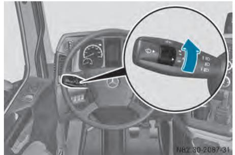
Interruptor del limpiaparabrisas situado en la palanca combinada
