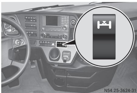
El eje adicional es un eje de arrastre dirigido electrónicamente-hidráulicamente que codirige el vehículo en función del ángulo de giro del volante al avanzar o retroceder. Con ello se reducen el desgaste de los neumáticos y el círculo de viraje del vehículo. El ángulo de viraje del eje adicional disminuye a medida que aumenta la velocidad y aumenta si la velocidad es menor. Con el vehículo parado, el eje de arrastre codirige por completo.
