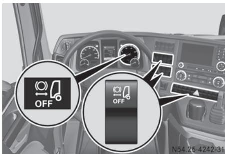
Al poner en marcha el motor, el sistema Active Brake Assist se conecta de forma automática.
