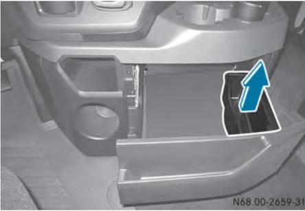
Bandeja para piezas pequeñas y compartimento para las gafas del compartimento deslizante (ejemplo de caja en el lado derecho)
