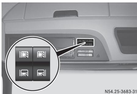
Si coloca la cerradura de encendido en la posición de marcha cuando las persianas no se encuentran en la posición final superior, se inicia un recorrido de referencia y las persianas se enrollan completamente.
