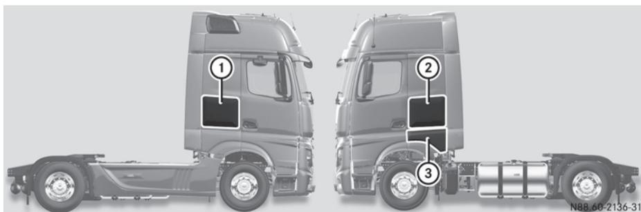
Compartimentos portaobjetos y caja portaherramientas (ejemplo de un tractocamión con cabina L)
