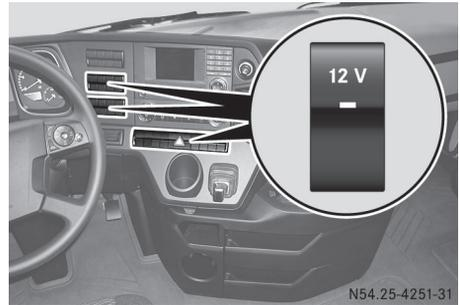
Tecla para el transformador de tensión de 12 V
