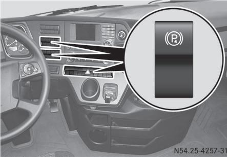
El freno de estacionamiento con acción sobre las cuatro ruedas acopla electroneumáticamente el freno de servicio y el freno de estacionamiento. El freno de estacionamiento con acción sobre las cuatro ruedas sirve para conseguir un apoyo seguro de los vehículos contra incendios, por ejemplo, al efectuar trabajos de salvamento con el cabestrante.
