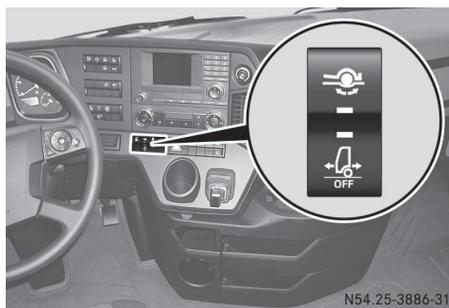
En el programa de acoplamientos **offroad**, el modo de marcha lenta adaptado para la marcha por carretera está desconectado. En los vehículos de tracción total esto es aplicable para todos los programas de marcha.
