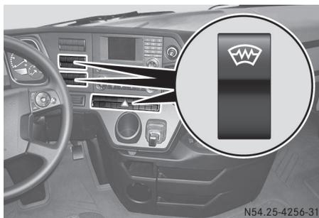
La calefacción del parabrisas solo puede conectarse con el motor en marcha, y se desconecta automáticamente después de aproximadamente 15 minutos.
