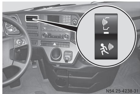
Tecla del sistema EDW con testigo de control y alarma de emergencia
