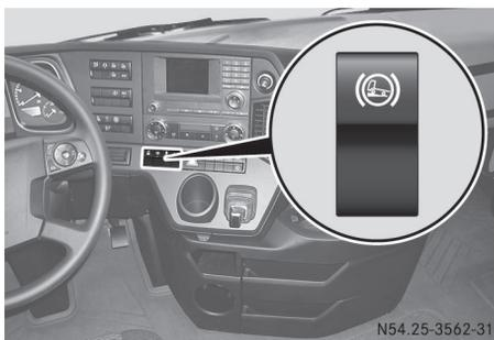
El bloqueo de desplazamiento le ayuda a arrancar el vehículo en una pendiente o un declive. El bloqueo de desplazamiento evita que el vehículo se desplace y ayuda a arrancar sin tirones.
