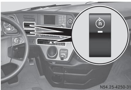
Si está conectado el mantenimiento constante del número de revoluciones, el sistema electrónico regula el régimen de trabajo programado para la toma de fuerza, con independencia de la carga.
