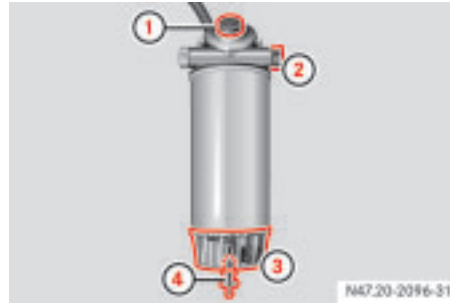
Filtro previo de combustible (en el lado derecho, detrás de la cabina)
