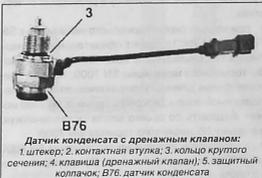
Датчик конденсата с дренажным клапаном:
