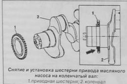
Снятие и установка шестерни привода масляного насоса на коленчатый вал:
