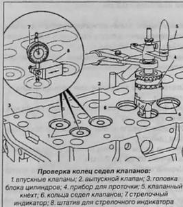
**Проверка колец седла клапанов:**
