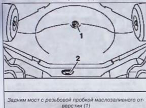
Задний мост с резьбовой пробкой маслосазливного отверстия (1)
