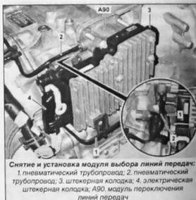
**Снятие и установка модуля выбора линий передач:**
