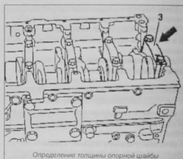
Определение толщины опорной шайбы
