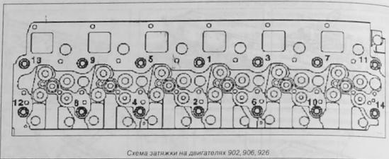
Схема затяжки на двигателях 902, 906, 926
