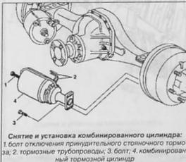
Снятие и установка комбинированного цилиндра:
