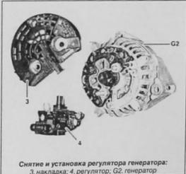
**Снятие и установка регулятора генератора:**
