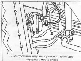
2. контрольный штуцер тормозного цилиндра переднего моста слева
