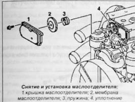
Снятие и установка маслоуделителя:
