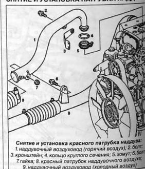
Снятие и установка красного патрубка наддува:
