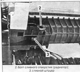
2. болт сливного отверстия (радиатор),
