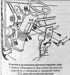
Снятие и установка датчика педали газа:
