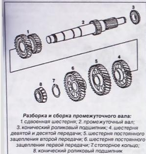
Разборка и сборка промежуточного вала:
