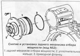
Снятие и установка заднего механизма отбора мощности (код N52): 1. задний механизм отбора мощности; 2. уплотнительное кольцо; 3. приводной фланец
