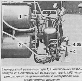
1, контрольный разъем контура 1; 2, контрольный разъем контура 2; 4, контрольный разъем контура 4; 4.05, четырехконтурный защитный клапан с интегрированным ограничителем давления
