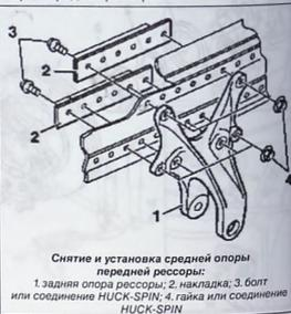
Снятие и установка средней опоры передней рессоры:
