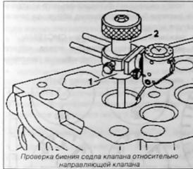
Проверка биения седла клапана относительно направляющей клапана
