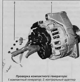
**Проверка компактного генератора:**
