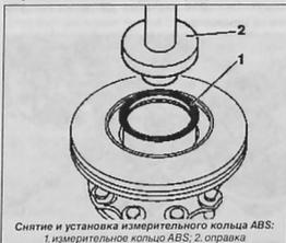
Снятие и установка измерительного кольца ABS:
