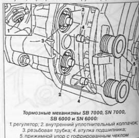
Тормозные механизмы SB 7000, SN 7000, SB 6000 и SN 6000:
