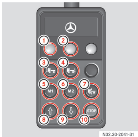
Panoul de comandă pentru sistemul de control al gărzii la sol
