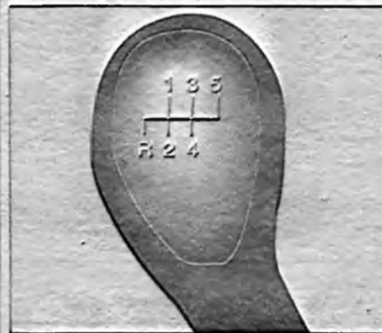
Рис. 1.59а. Схема переключения передач (модели до 2000 г. выпуска).
