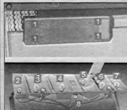
Рис. 1.86а. Расположение лампочек заднего фонаря (модели до 2000 г. выпуска):
