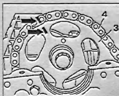
Рис. 4.25. Пометьте расположение цепи 4 и звездочки 3 распределительного вала относительно друг друга (стрелка).
