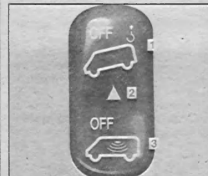
Рис. 1.21б. Кнопка включения сигнализации автомобиля с защитой от буксировки и защиты кабины/салона.
