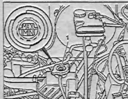
Рис. 2.2. Открутите и снимите крышку радиатора (1).
