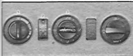
Рис. 1.44. Регуляторы системы отопления и вентиляции: 1 – Регулятор температуры воздуха; 2 – Регулятор подачи воздуха вентилятором; 3 – Регулятор распределения воздуха.
