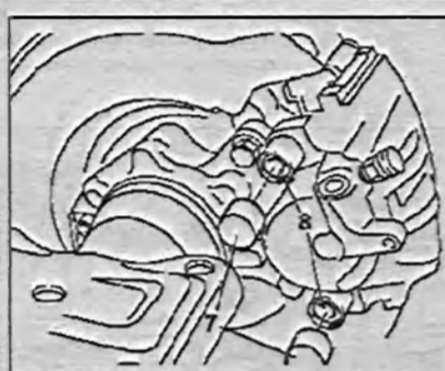
Рис. 8.17. Снимите защитные крышки 7 с направляющих пальцев.
