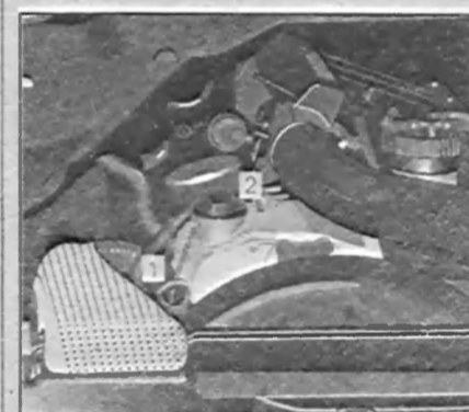
Рис. 1.70а. Проверка уровня и доливание моторного масла (модели 208 CDI, 211 CDI, 213 CDI, 308 CDI, 311 CDI, 313 CDI, 408 CDI, 411 CDI, 413):
