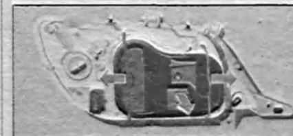
Рис. 1.78. Переместите хомуты в стороны (стрелки) и снимите крышку лампочек блок-фары в направлении стрелки.
