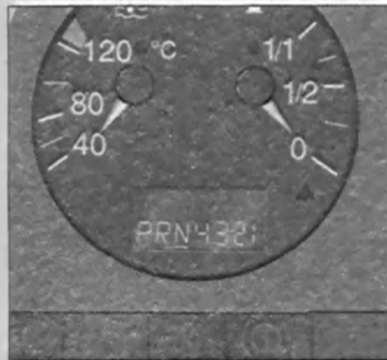
Рис. 1.6а. Указатель уровня топлива с сигнальной лампочкой запаса (автомобили до 2000 г. выпуска).
