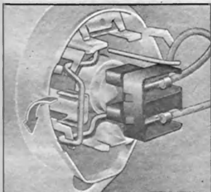
Рис. 1.80. Снятие лампочки ближнего света фары.
