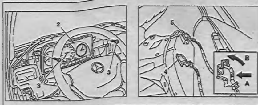
Рис. 9.6. Снятие и установка щитка приборов: 2 – Щиток приборов; 3 – Винты; 4, 5 – Разъемы проводки.
