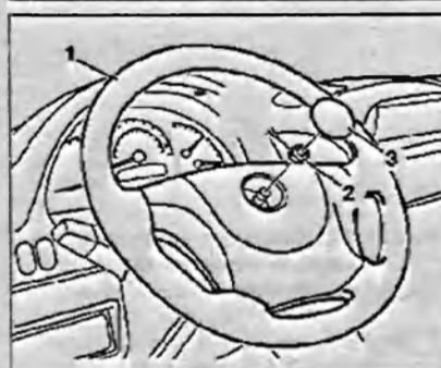
Рис. 7.3. Снятие и установка рулевого колеса: 1 - Рулевое колесо; 2 - Гайка; 3 - Крышка с логотипом.
