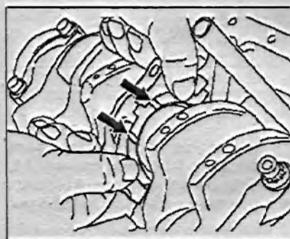
Рис. 4.61. Установка регуляторов осевого зазора.
