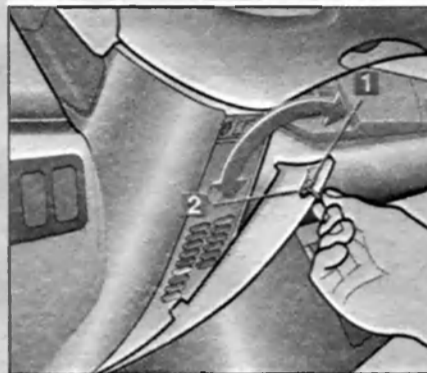
Рис. 1.71. Блок предохранителей снизу возле рулевой колонки: 1 – Крышка закрыта; 2 – Крышка открыта.
