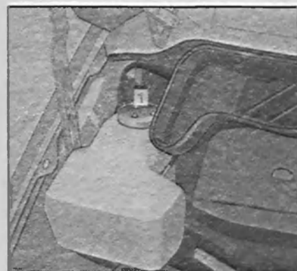
Рис. 1.67. Проверка уровня жидкости в бачке стекло- и фароомывателей.
